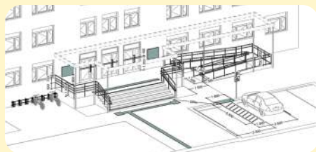
Схема облаштування шляху руху до входу у будівлю (розміри вказані у мм)
